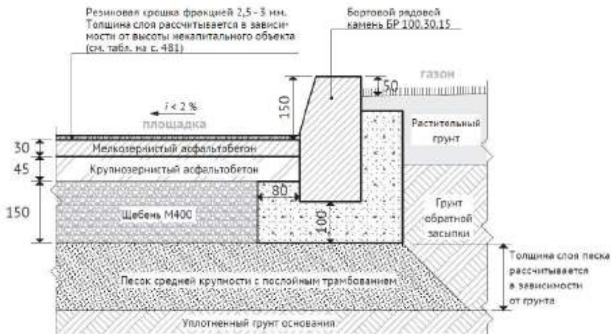
Илл. 3.1.11. ПРИНЦИПАЛЬНАЯ СХЕМА УСТРОЙСТВА СОПРЯЖЕНИЯ ПОКРЫТИЯ ДЕТСКОЙ ПЛОЩАДКИ И ГАЗОНА (РЕШЕНИЕ УТОЧНЯЕТСЯ ИНДИВИДУАЛЬНО В ПРОЕКТЕ В ЗАВИСИМОСТИ ОТ МЕСТНЫХ УСЛОВИЙ)
